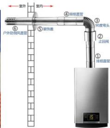
燃气热水器排烟管安装示意图
