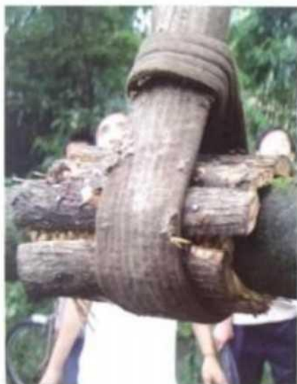
1、装车前在起吊位系结软绳
