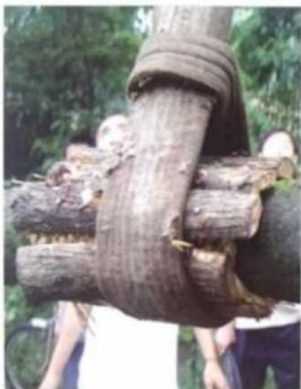
1、装车前在起吊位系结软绳
