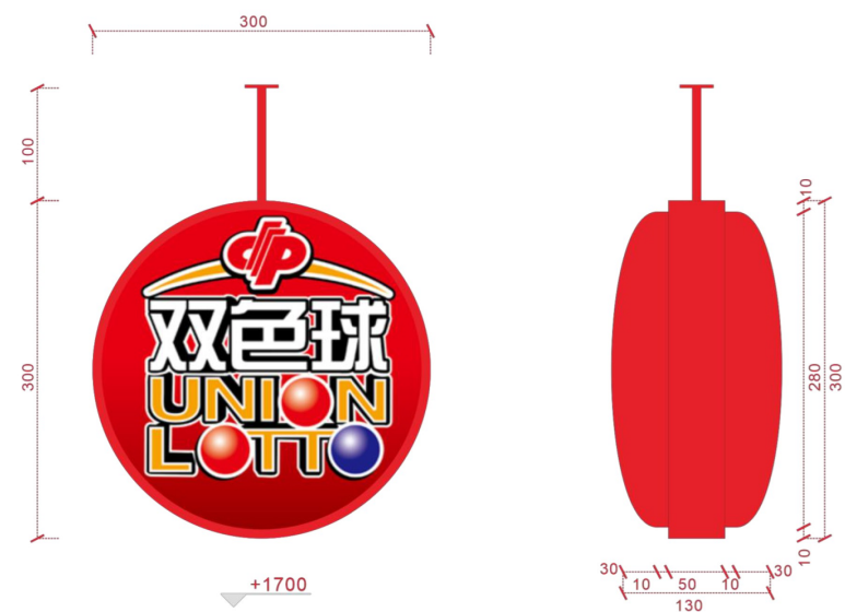
500mm高造型门头配置吸塑灯箱尺寸图
