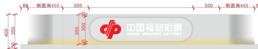
400mm高烤漆板造型门头长度尺寸规范示意图（中岛式放置）
