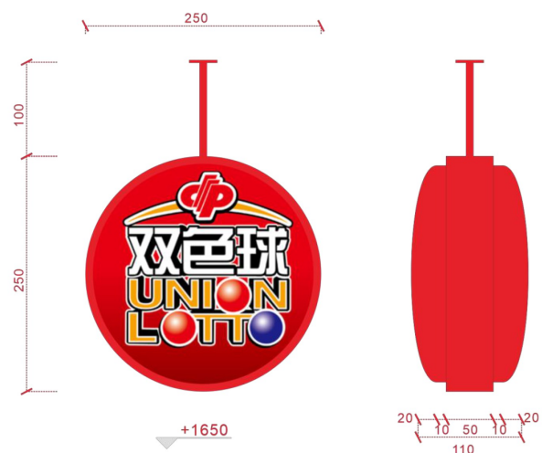
400mm高造型门头配置吸塑灯箱尺寸图
