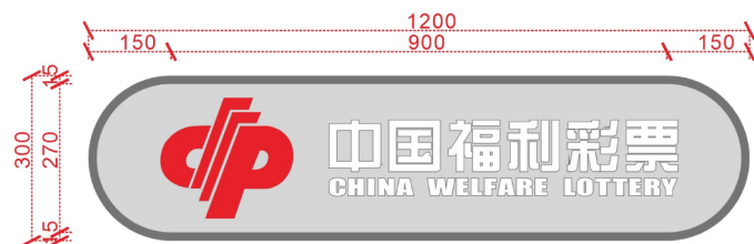
烤漆板造型门头剖面尺寸图
