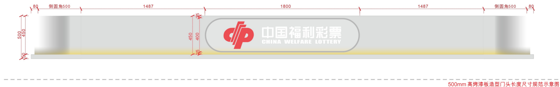
500mm 高烤漆板造型门头长度尺寸规范示意图
