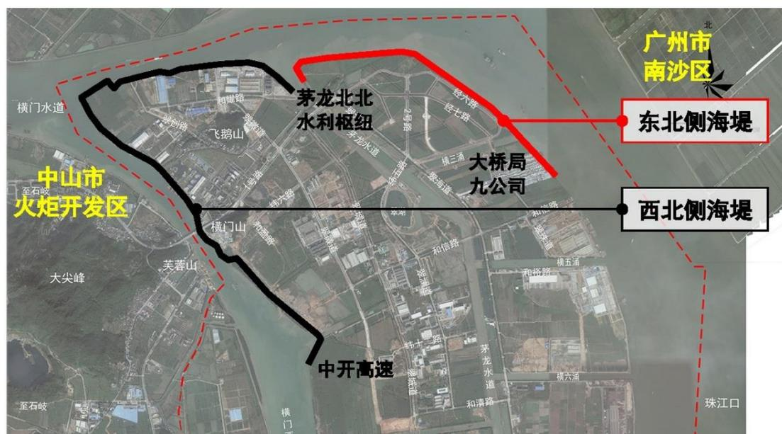
图 2.1.2-1 横门岛外围海堤加固范围示意图
