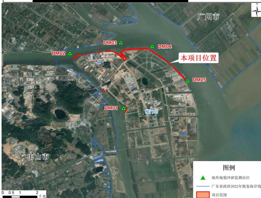
图 8.4.5-3 地形地貌与冲淤监测断面图
